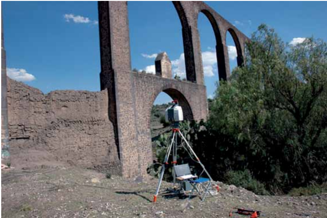
FIGURA 2. Trabajo de levantamiento con el escáner láser de la arquería monumental del Acueducto del Padre Tembleque, en la sección de la Barranca de Tepeyahualco, municipio de Zempoala, Hidalgo, y Nopaltepec, Estado de México, 2010. (Cortesía: LIAD, CNMH-INAH).
