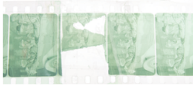
FIGURA 3. Imagen de fotogramas de nitrato negativo mutilados por degradación del material. (Fotografía: Laboratorio de restauración de la Cineteca Nacional, 2015; cortesía: Cineteca Nacional, México).
