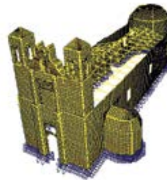
FIGURA 4. Modelo tridimensional en elemento finito (Modelo: Figueroa Esquinca, 2009).
