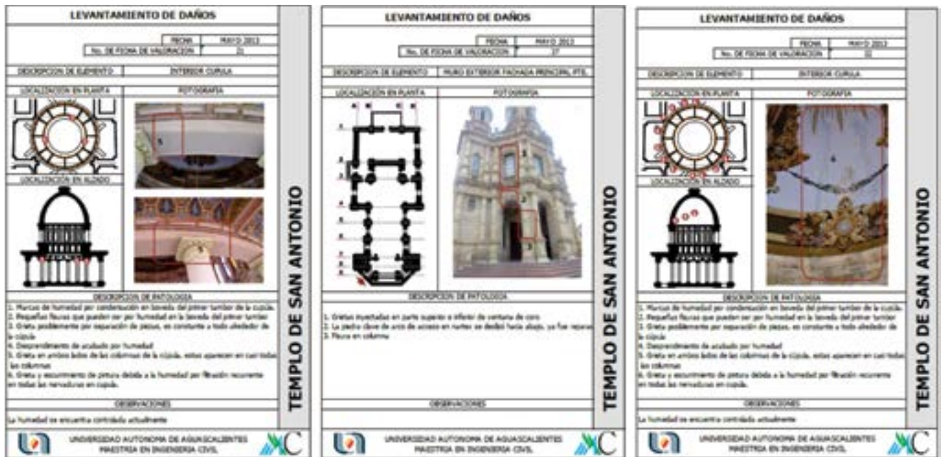
FIGURA 5. Fichas de levantamiento de daños del templo de San Antonio de Padua (Ilustración: Edith Orenday-Tapia, 2019; fuente: M. Navarro 2013).
