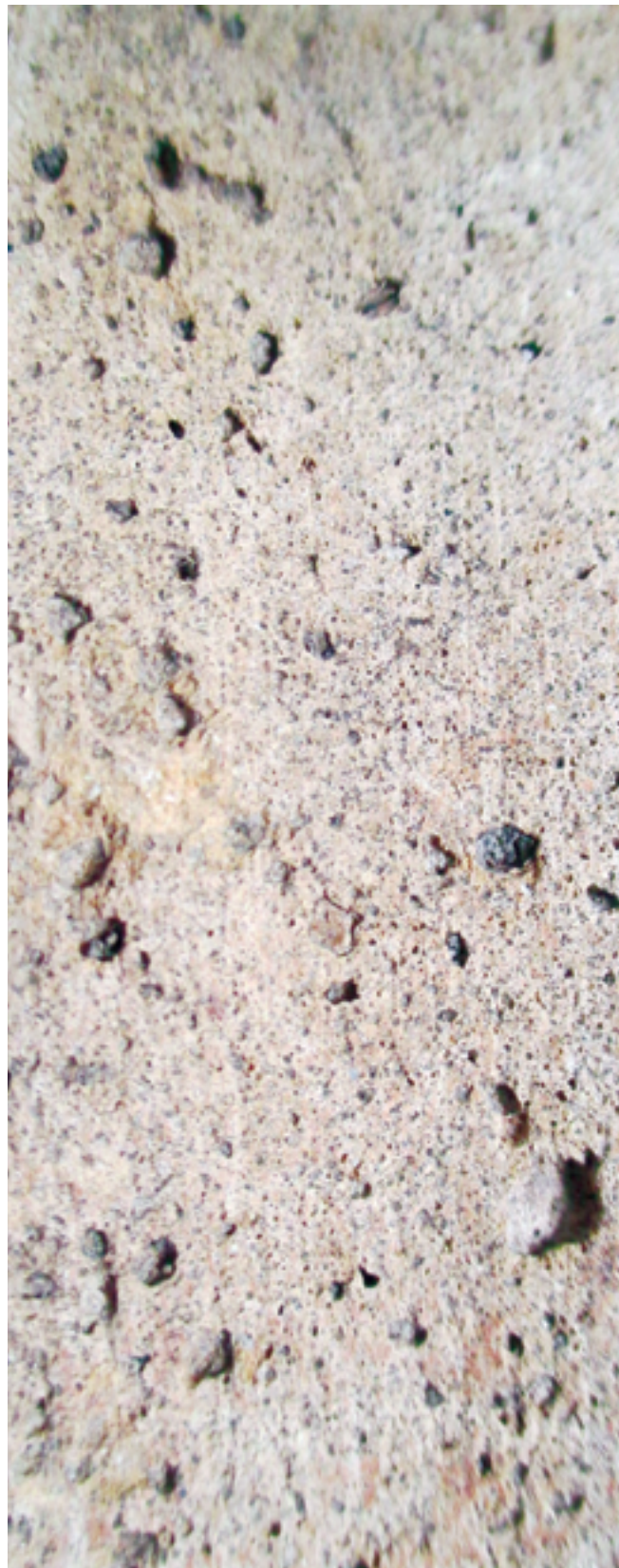
FIGURA 2. Detalle donde se aprecia la abundancia de partículas negras vítreas y la porosidad generada por el desprendimiento de dichas partículas al alterarse (Fotografía: Julio César Martínez, 2016; cortesía: Coordinación Nacional de Conservación del Patrimonio Cultural [CNCPC-INAH], México).
