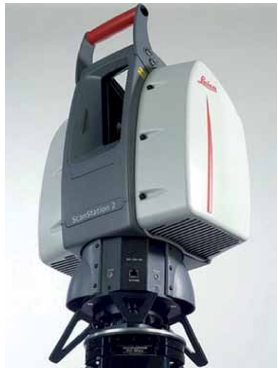
FIGURA 3. Equipo empleado por el LIAD, CNMH-INAH: Leica ScanStation 2. Campo de visión horizontal 360 y vertical 270. Formación de 111 imágenes digitales con rectificado espacial. Alcance de 300 m de reflectividad. Margen de error: 2 mm. (Cortesía: LIAD, CNMH-INAH).
