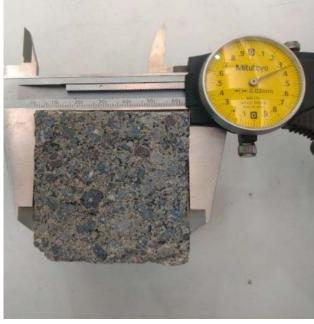
FIGURA 4. Tres imágenes que muestran el proceso de preparación de la pieza en 2020. Para adquirir la resistencia a la compresión, se aplicó una carga a una velocidad constante y paralela a la dirección longitudinal de la probeta, registrando la carga máxima a la falla (F<sub>ult</sub>), similar a lo realizado por otros investigadores (Fotografías: Alejandro Leal y Alberto Muciño, 2021; fuente: colección de los autores).
